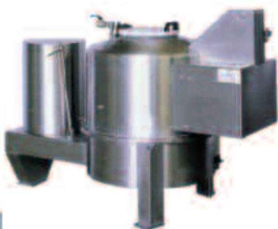
CENTRIFUGA PER TRIPPA E MACCHINA RASA TESTE E ZAMPINI
